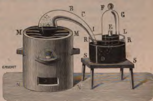
Fig. 88. — Analyse de l'air par Lavoisier.
